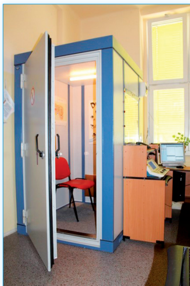
Obr. 2: Audiometrická komora pro tónovou audiometrii
